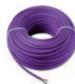
▲ 732I.C.100 Кабель Due Fili Plus для внутренней/наружной прокладки, проводники с витыми парами 2x1 мм 2 , изоляция и оболочка LSZH (малодымный безгалогенный компаунд), класс Cca - s1b, d1, a1, рабочая температура -25/+70 °C, класс изоляции 600/1000 В, пригоден для подземной прокладки в сухих трубах или трубах с дренажом (макс. время нахождения в мокром состоянии 24 ч), непригоден для прокладки непосредственно в земле, пригоден для укладки в одном коробе с кабелями I категории (U0 = 400 V), фиолетовый - моток длиной 100 м
