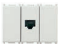
14505.AB Релейный модуль с гнездом RJ45 для пульта 2 свет + 2 AUX, подключение к модулю 8IN/8OUT или дисплею Call-way, 4 релейных выхода 24 V NO, антибактериальная обработка - 3 модуля. Глубина: 29,5 мм
