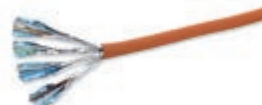
03086.E Кабель кат. 6A S/FTP, Экранированный, 4 пары, 23 AWG, с оплеткой LSZH, класс CPR Еса, пригодный для укладки в одном коробе с кабеля- ми I категории (U0 = 400 V), оранжевый - 500 м
