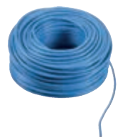
732H.E.100 Кабель Due Fili Plus для внутренней прокладки, проводники с витыми парами 2x1 мм 2 , ПВХ оболочка, класс CPR Eca, рабочая температура -25/+70 °C, не предназначен для прокладки в подземном лотке, пригоден для укладки в одном коробе с кабелями I категории (U0 = 400 V) синий - моток длиной 100 м
