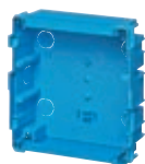
V53308 Коробка для каменных стен - 8 модулей (GW 650°C). Рассеиваемая мощность: 18 Вт
