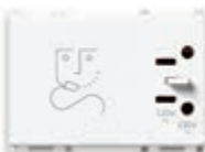
14290.AB Розетка для электробритв с изолирующим транс- форматором 20 ВА, выход 230 В~ и 120 В~ - 3 модуля. Глубина: 41 мм
