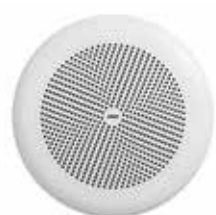
01906 Пассивный динамик IP55, 8 Ω 30 Вт, для полых стен и подвесных потолков монтаж. Глубина: 70 мм
