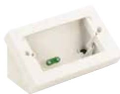
▲30784.B Наклонная настольная монтажная коробка с изменяемой высотой для установки 4 модулей. В заниженной версии можно устанавливать блоки максимальной глубиной 32 мм; при повороте крышки максимальная глубина увеличивается до 44 мм. Розетку с USB, 30210.USB, установить невозможно. Необходимы суппорт и накладка.
