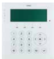
▲ 03817 Клавиатура с ЖК-дисплеем, блок питания 12 В постоянного тока, 23 клавиши с подсветкой, 5 светодиодов состояния, монтаж на поверхность. Размеры: 140,3x150,3x21,6 мм
