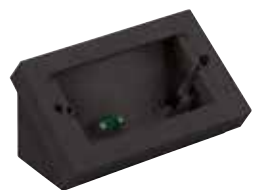
▲30784.G Наклонная настольная монтажная коробка с изменяемой высотой для установки 4 модулей. В заниженной версии можно устанавливать блоки максимальной глубиной 32 мм; при повороте крышки максимальная глубина увеличивается до 44 мм. Розетку с USB, 30210.USB, установить невозможно. Необходимы суппорт и накладка.
