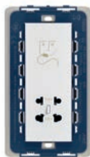
19291.B 6 230 В~ 50/60 Гц, с разделительным трансформатором 20 ВА, 230 В~ и 120 В~ выходы. Глубина: 41,5 мм
