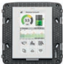
21511.1.B Сенсорный экран 4,3" Full Flat, для контроля и управления, вход для подключения датчика температуры, с держателем для установки в коробки на 8 модулей. Глубина: 39,9 мм
