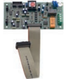
01708 Коммутатор PSTN (TCOP), для центрального пульта управления
