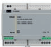
01901 Стереоусилитель 2 выхода для диффузоров звука 8 Ω 10+10 Вт, пита- ние 110-230 В 50/60 Гц, встроенный ограничи- тель линии, 6 модуля x 17,5 мм
