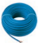
01840.E.B Кабель для Звуковое вещание, 2x0,50 мм 2 , с оболочкой LSZH, класс CPR Eca, пригодный для укладки в одном коробе с кабелями I категории (U0 = 400 V), синий цвет - 100 м
