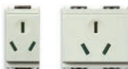
16251.B SICURY 2П+3 10 А, китайский стандарт. Глубина: 26 мм 16254.B SICURY 2П+3 16 А, китайский стандарт - 2 модуля. Глубина: 27,8 мм
