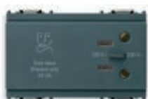
16290 230 В~ 50/60 Гц, с изолирующим трансформатором 20 ВА, выходное напряжение 230 В~ и 120 В~ - 3 модуля. Глубина: 46 мм
