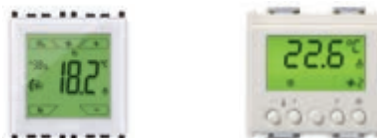
02952.B Электронный термостат с сенсорным экраном для контроля температуры в 2 зонах по отдельности, стандарт KNX, 1 НР релейный выход 4 А 24 В~, 1 вход для подключения датчика температуры или 02965, 1 программируемый цифровой вход - 2 модуля. При монтаже использовать специальную монтажную рамку 16723.B. Глубина: 38,5 мм
