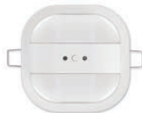
01529.1 Сенсор с инфракрасным датчиком присутствия с углом 360° для включения и выключения освещения в зависимости от уровня освещенности и/или движения, регулируемый диапазон яркости 1 -1000 лк, стандарт KNX, потолочная установка. Размеры: 91x91x45 мм
