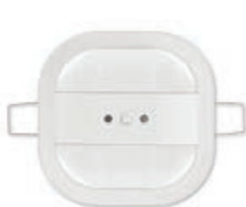
01527 Сенсор с инфракрасным датчиком присутствия с углом 360°, для включения, выключения и постоянной регулировки уровня освещения, отопления, искусственного климата, вентиляции в зависимости от уровня освещенности и/или движения, регулируемый диапазон яркости 1-1000 лк, стандарт KNX, потолочная установка. Размеры: 80x80x45 мм
