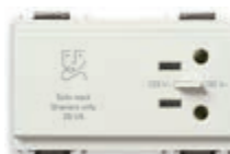
16290.B 230 В~ 50/60 Гц, с изолирующим трансформатором 20 ВА, выходное напряжение 230 В~ и 120 В~ - 3 модуля. Глубина: 46 мм
