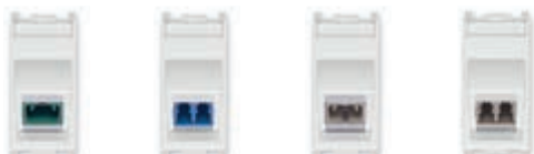
▲14350.SC Одномодовый 9/125 мкм, с адаптером типа SC/APC simplex. Глубина: 19,4 мм ▲14350.LC Одномодовый 9/125 мкм, с адаптером типа LC duplex. Глубина: 19,6 мм ▲14351.SC Многомодовый 50/125 мкм, с адаптером типа SC simplex. Глубина: 19,4 мм ▲14351.LC Многомодовый 50/125 мкм, с адаптером типа LC duplex. Глубина: 19,6 мм
