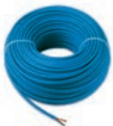
01840.B Безгалогенный кабель для диффузора звука 2x0,50 мм 2 , обеспечивает изоляцию от земли для номинального напряжения 400 В и, следовательно, пригодный для укладки в одном коробе с кабелями I категории, синий цвет - 100 м
