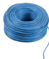
732H/100 Кабель Due Fili Plus для внутренней прокладки, проводники с витыми парами 2x1 мм 2 , ПВХ оболочка, рабочая температура -25/+70 °С, класс изоляции 450/750 В, не предназначен для прокладки в подземном лотке - моток длиной 100 м
