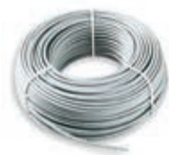
01840 Кабель для системы Bus, безгалогенный, 2x0,50 мм 2 , обеспечивает изоляцию от земли для номинального напряжения 300/500 В и, следовательно, пригодный для укладки в одном коробе с кабелями I категории, белая - 100 м
