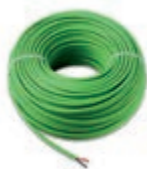
732I/100 Кабель Due Fili Plus для внутренней/наружной прокладки, проводники с витыми парами 2x1 мм 2 , изоляция и оболочка LSZH (малодымный безгалогенный компаунд), рабочая температура -25/+70 °С, класс изоляции 600/1000 В, пригоден для подземной прокладки в сухих трубах или трубах с дренажом (макс. время нахождения в мокром состоянии 24 ч), непригоден для прокладки непосредственно в земле - моток длиной 100 м
