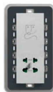
20291.N 6 230 В~ 50/60 Гц, с разделительным трансформатором 20 ВА, 230 В~ и 120 В~ выходы. Глубина: 41 мм
