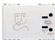
20290.B 230 В~ 50/60 Гц, с разделительным трансформатором 20 ВА, 230 В~ и 120 В~ выходы - 3 модуля. Глубина: 42 мм
