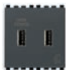
20295 Блок питания 5 В 2,1 А, 2 USB-выхода с общим током 2,1 А, 120-230 В~ 50/60 Гц - 2 модуля. Глубина: 37 мм
