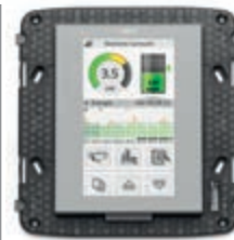
21511.1.BN Сенсорный экран 4,3" Full Flat, для контроля и управления, вход для подключения датчика температуры, с держателем для установки в коробки на 8 модулей. Глубина: 39,9 мм
