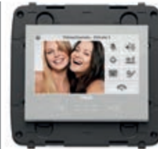
21554.BN Сенсорный видеозэкран 4,3" Full Flat, для внутреннего поста системы видеодомофонии Due Fili Plus, служащий для контроля и управления, вход для подключения датчика температуры, с держателем для установки в коробки на 8 модулей. Глубина: 46,7 мм
