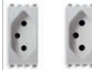
20264.N 2П+3 10 А, бразильский стандарт. Глубина: 31,5 мм 20265.N 2П+3 20 А, бразильский стандарт. Глубина: 31,5 мм
