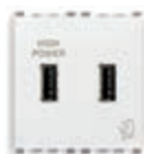
20295.B Блок питания 5 В 2,1 А, 2 USB-выхода с общим током 2,1 А, 120-230 В~ 50/60 Гц - 2 модуля. Глубина: 37 мм
